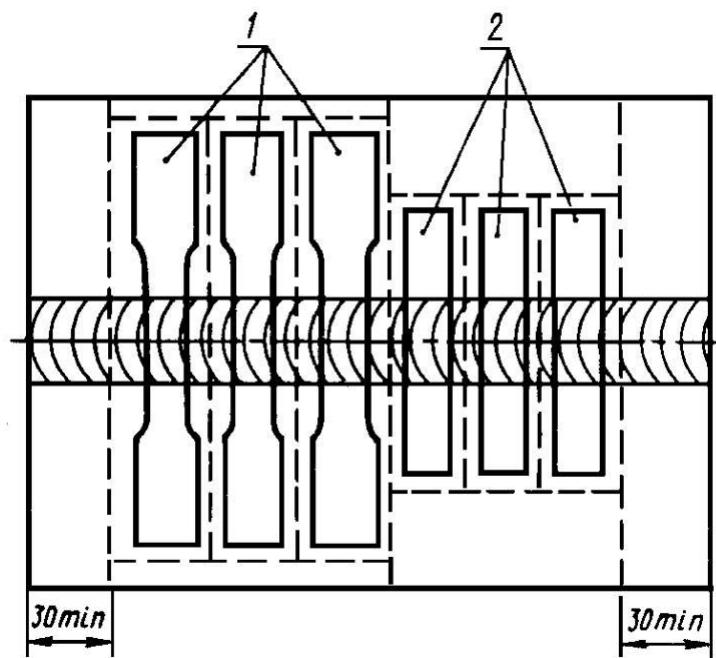
1 - образцы для испытания на статическое растяжение;
