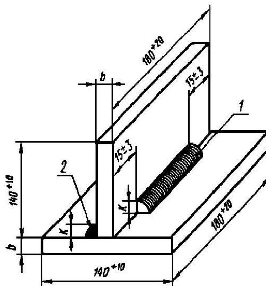
1 - контрольный сварной шов; 2 - сварной шов, обеспечивающий жесткость образца
